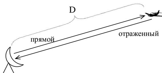
Т.о. сигнал испущенный антенной РЛС вернется на нее в отраженном виде через время  $t_D = t_{\text{прямого}} + t_{\text{отп}} = 2t$ . СВЧ сигналы распространяются с постоянной скоростью, поэтому  $D = c \cdot t$ . Мы учли, что скорость распространения СВЧ сигнала в воздухе примерно равна его скорости распространения в вакууме -  $c$ . Учтем предыдущее выражение, и запишем равенство, определяющее дальность  $D$  в зависимости от времени запаздывания  $t_D$ :
