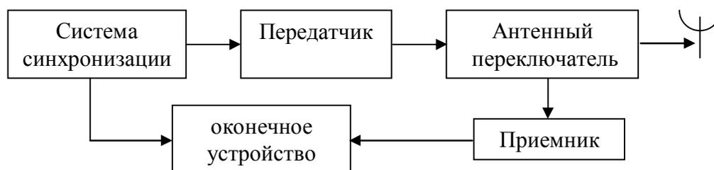
Система синхронизации определяет импульсную работу РЛС. Она формирует видеоимпульсы через постоянные промежутки времени  $T_u$ .  $T_u$  называют периодом повторения импульса. Т.о. система синхронизации определяет период работы – один цикл определения дальности.
