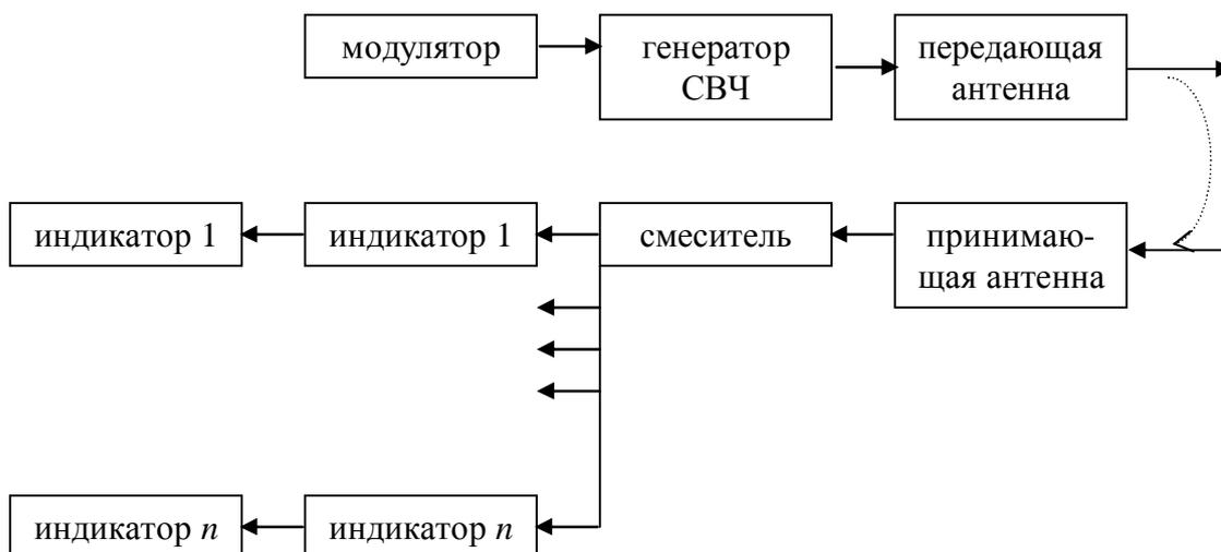
Модулятор формирует модуляцию частоты, вырабатываемой генератором СВЧ. После чего сигнал поступает на передающую антенну. Т.к. сигнал непрерывный, то требуется еще и отдельная принимающая антенна.
