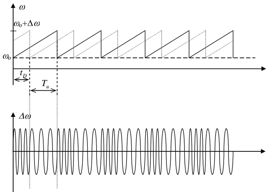
Из графиков видно как определить время запаздывания – по резкой перемене в частоте разностного сигнала. Очевидно также, что в формулу (2.4) надо подставлять значение разностной частоты, полученное на промежутке времени ( $t_D ; T_u$ ).
