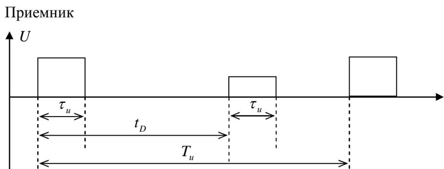
Из равенства (1.1) следует, что  $t_D \sim D$ . Т.о. выведя последний график на систему индикации (оконечное устройство), и соответствующим образом градуировав шкалу, будем иметь непосредственно значение дальности до цели.
