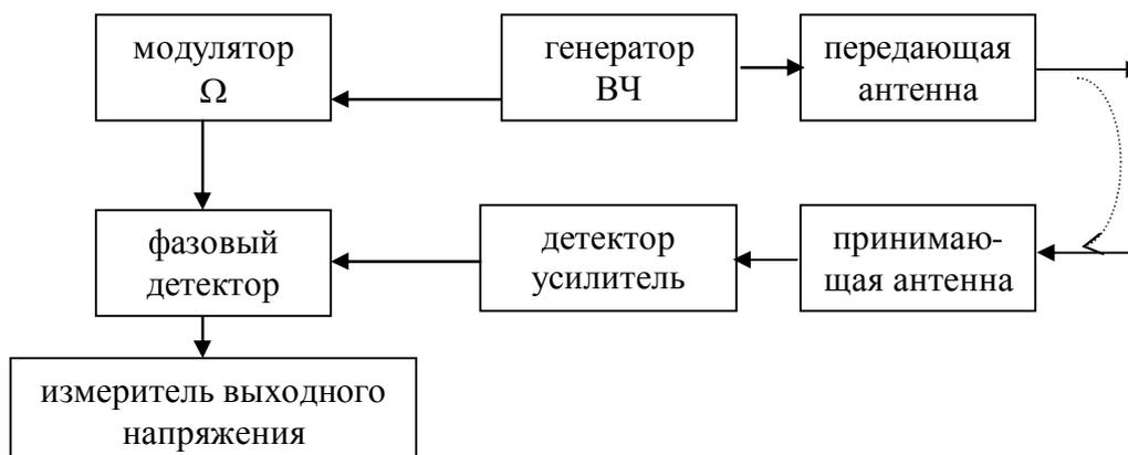
Здесь частота  $\Omega$  определяет фазовые сдвиги, а  $\omega_0$  играет роль переносчика информации.
