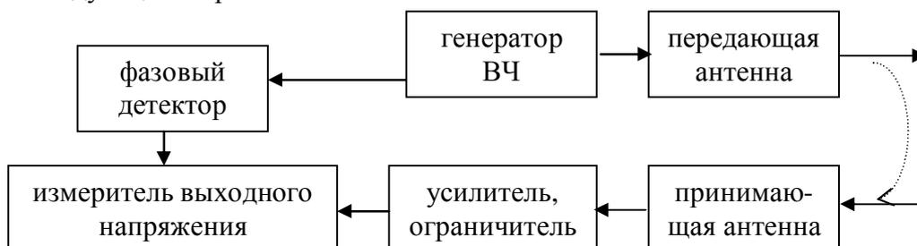
Генератор ВЧ создает колебания, которые через передающую антенну излучаются во внешнее пространство с соответствующей фазой:
